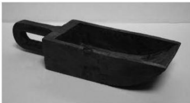
Écobe taillée dans une seule pièce de bois par les menuisiers, pour les canots de sauvetage
