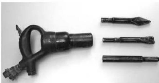
Pistolet à air comprimé pour le matage des rivets et pour chanfreiner et embouts divers (matoir, burin, pointe).
