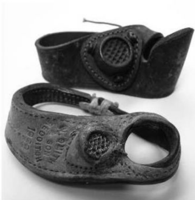
poussoir à aiguille composé d'un protège-paume en cuir et d'un dé en fer.
