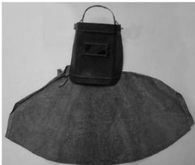
Masque de soudeur et collerette de protection en cuir pour la soudure au plafond.
