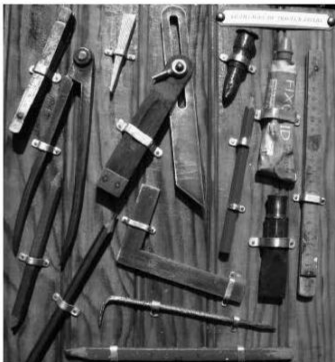
Principaux outils d'un traceur (compas, règles, pointeaux, aiguille...)
