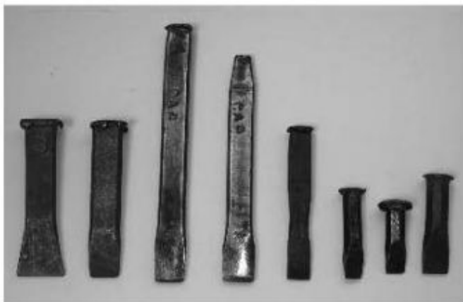
Série de coins servant à soulever ou écarter des pièces de métal ou des tôles
