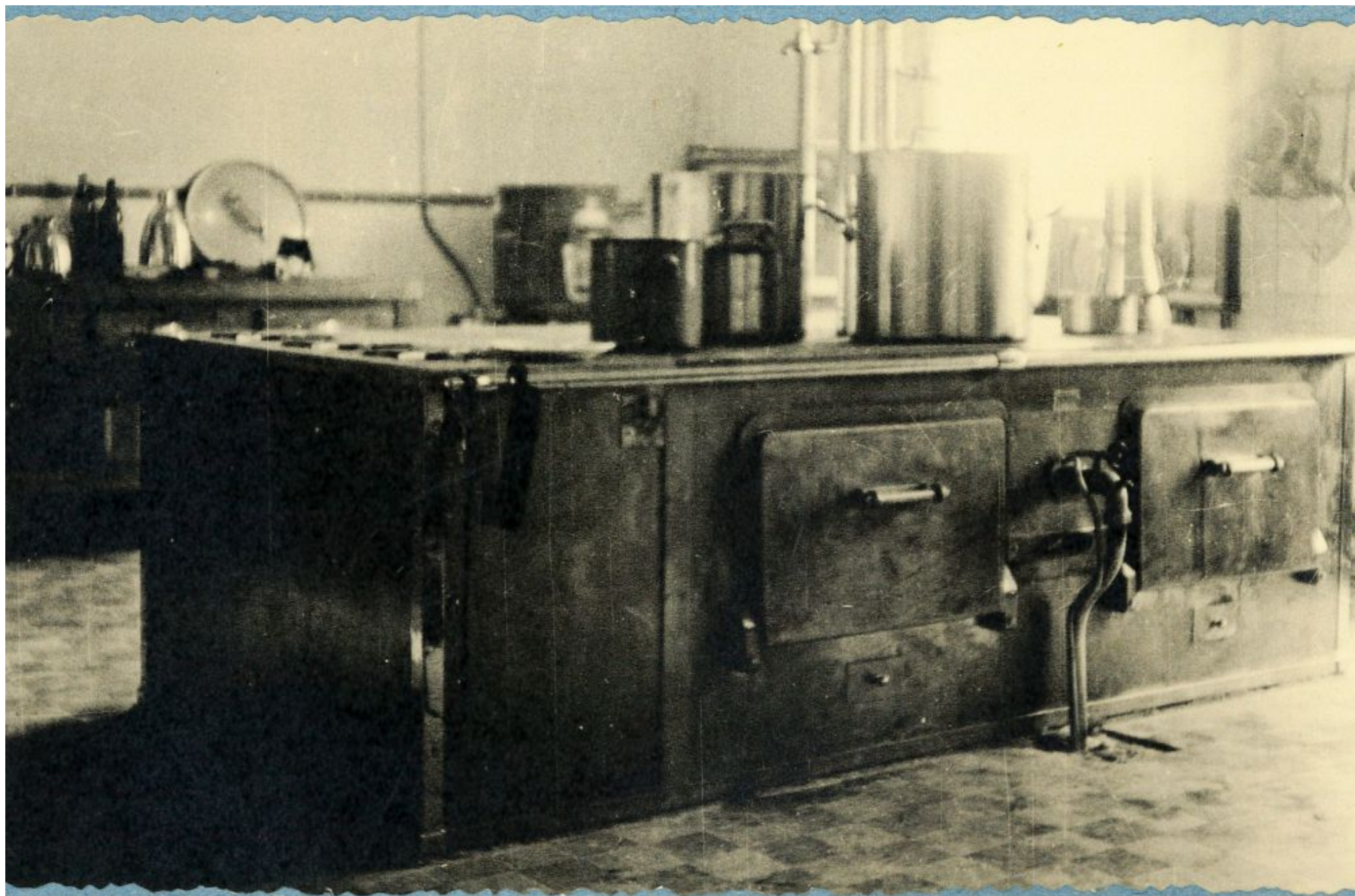
Fourneau au Mazout
